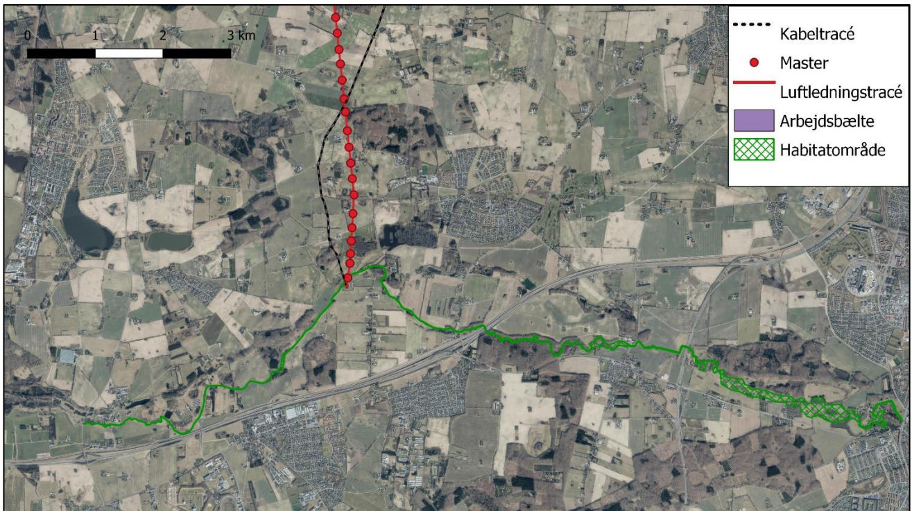
Figur 5-11. Habitatområde H31 Køge Å. Området krydses af den eksisterende luftledning og den nye kabellægning.
