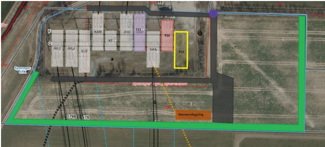
Figur 2-8. Oversigt over anlægsaktiviteter på Spanager. Skitsering af udvidelsen med transformere T11, reaktor R11, adgangsveje og parkeringsareal, manøvrebygning. Grøn = beplantningsbælte. Blå strek = stationsafgrænsning. Lilla prik = ny adgang til stationen.
